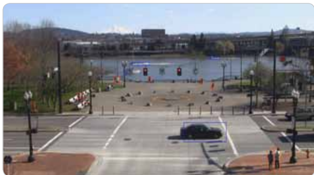
Obr. Automatické rozpoznanie objektov – modrá reprezentuje vozidlo (auto, loď) a červená osoba
