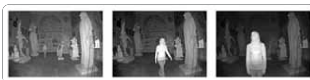
Obr. Snímky ukazujú, ako sa pri kamerách so zabudovaným optimalizovaným IR nasvetlením mení expozícia podľa toho, ako sa subjekt približuje ku kamere
